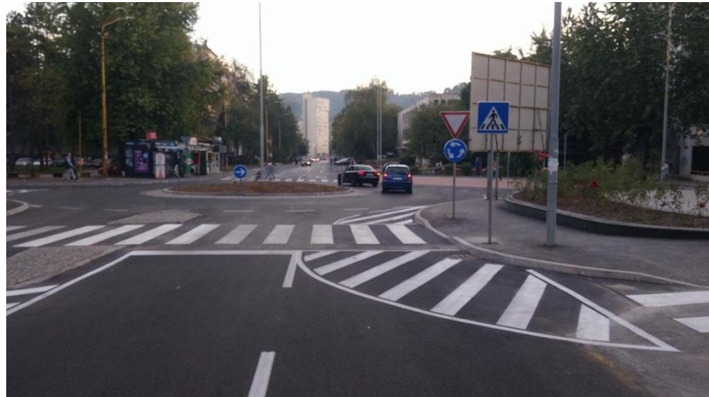
*Fotografija br. 59. Obratiti pažnju na punu liniju zaustavljanja (VI-11) na kolovozu i znak „nailazak na put sa pravom prvenstva“ (II-1) koji su u koliziji*
