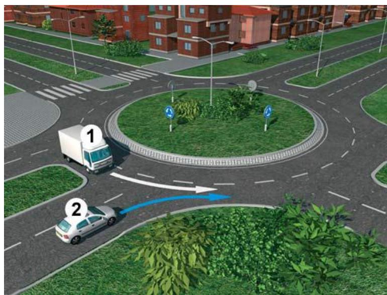
Fotografija br. 46. Kružni tok saobraćaja regulisan „pravilom desne strane“
