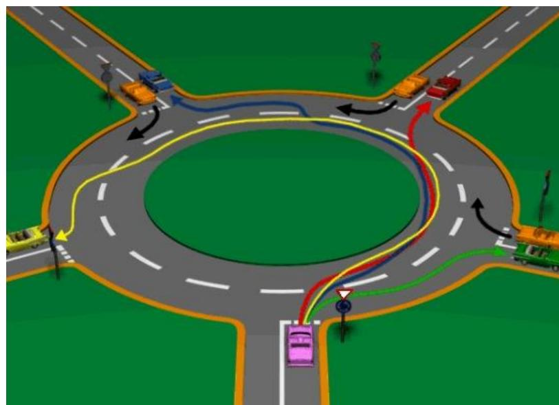
Fotografija br. 45. Izgled raskrsnice sa kružnim tokom saobraćaja regulisane H i V saob. signalizacijom
