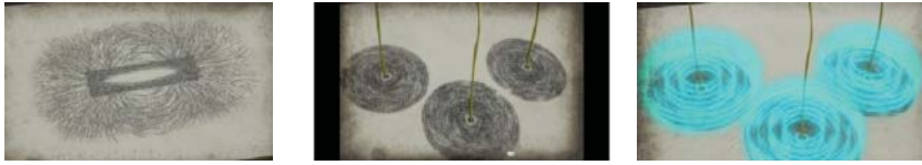
Sl. 12. Slika nevidljivog utjecaja se učini vidljivim željeznim opiljcima. Oblik utjecaja pokretnog naboja, struje, stvara utjecaj kao i magnet.
