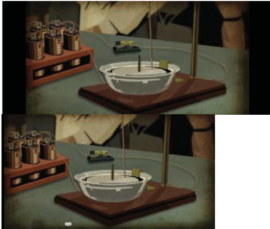
Sl. 6. Prvi motor koji elektricitet prevodi u mehanički pokret.
