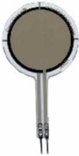
Slika 34. FlexiForce rezistivni senzor sila, model 401 (proizvedeno u Tekscan, USA)
