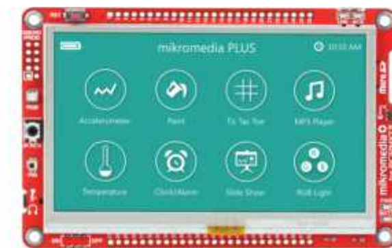
Slik 39. l ktr nski ur z m r nj , kvizici u, num ri ki i gr fi ki prik z m r nih vr dn sti, izgl d s pr dnj str n (MikroElektronika)
